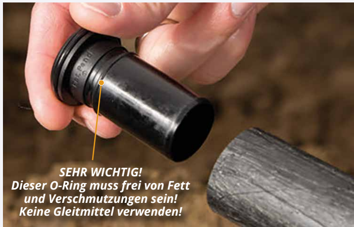
Kunststoffrohr rechtwinklig abschneiden und entgraten.
